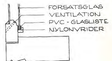
VINDUE MED FORSATSGLAS PÅ VINDUESRAMMERNE
